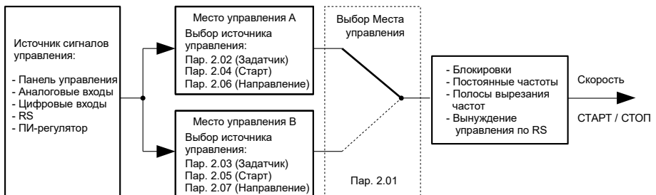
Рис. 5.1. Упрощенная структура управления преобразователем AFC200
